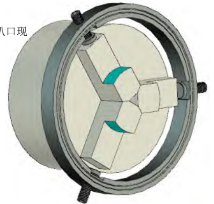
示意图：修爪器锁紧后，车削胀撑圆弧（绿色位置）
